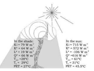
Fig. 8 – Median of the results of the measurements made in the sun and in the shade Fig. 8 – Mediana dos resultados das medições à sombra e ao Sol
